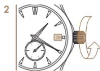
*Das aktuelle Datum durch Drehen der Krone im Uhrzeigersinn einstellen.*
