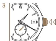
*Poussez la couronne pour la replacer en position initiale. L'aiguille des secondes se remet en marche.*
