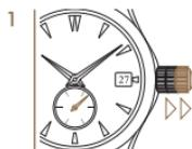
1 Вытянуть заводную головку, переведя ее в положение 2. Секундная стрелка неподвижна.
