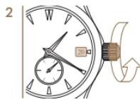
*Réglez la date en tournant la couronne dans le sens des aiguilles d'une montre.*
