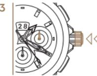
リューズを元のポジション1に押し戻します。秒針が再び動き始めます。
