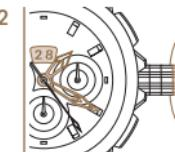
Tournez la couronne dans le sens inverse des aiguilles d'une montre jusqu'à ce que la date change; réglez l'heure sur a.m. ou p.m.
